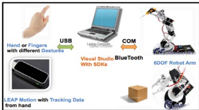
Hình 4: Cấu hình cơ bản của một hệ thống điều khiển cánh tay robot bằng Leap Motion
