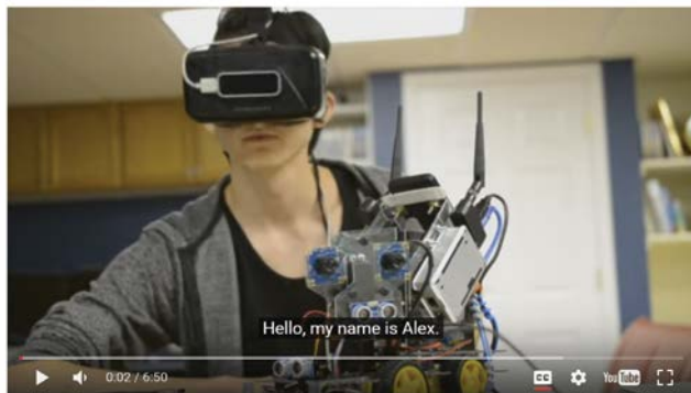
Hình 3: Ứng dụng Leap motion kết hợp kính thực tại ảo để điều khiển robot quay phim
