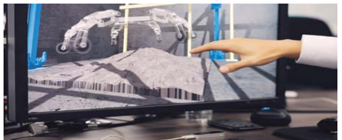
Hình 2: Ứng dụng Leap motion điều khiển cánh tay robot Athlete của NASA
